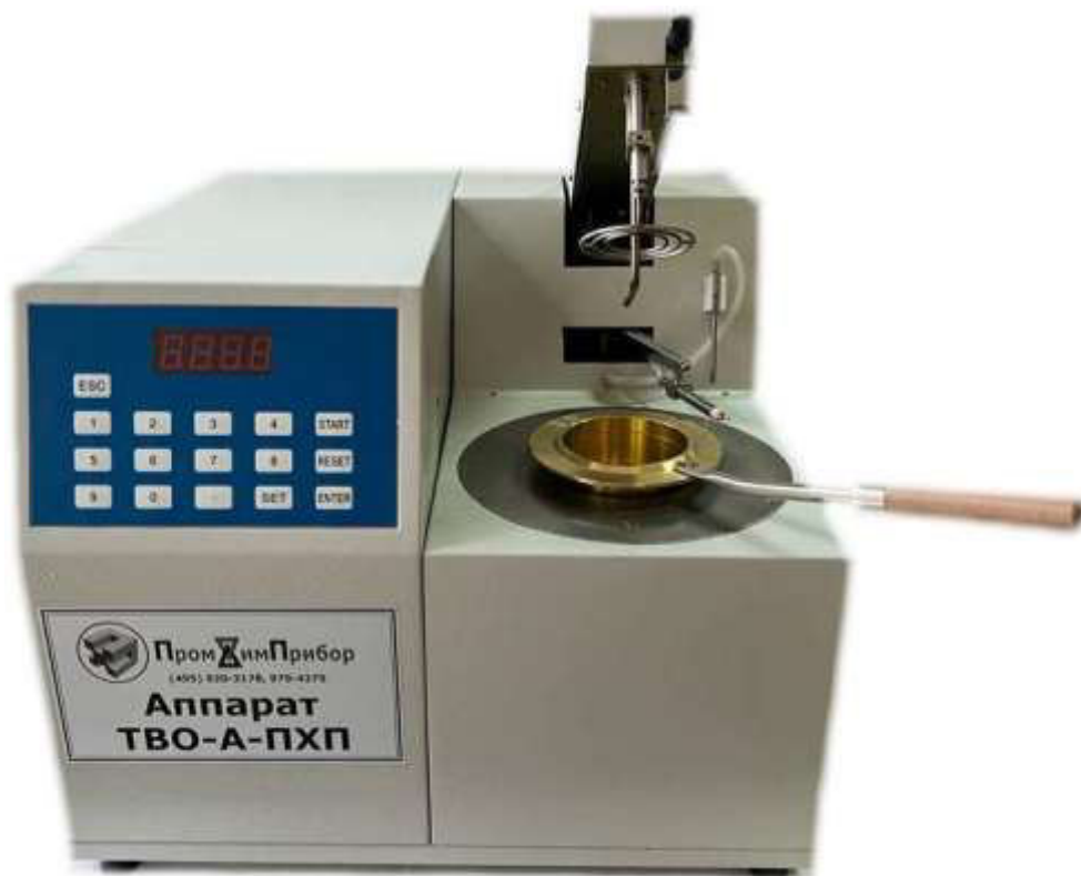
Рис. 1. Внешний вид аппарата ТВО-А-ПХП
