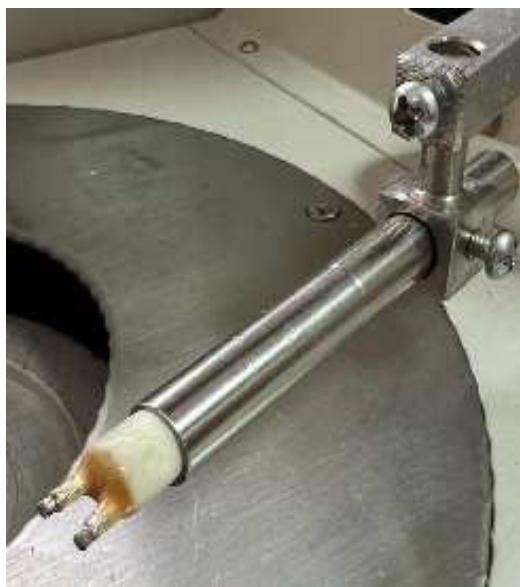
Рис. 5. Внешний вид электрического и газового воспламенителей
