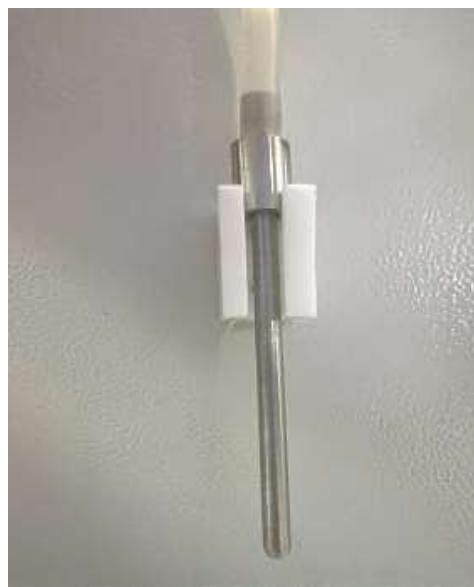
Рис. 5. Внешний вид электрического и газового воспламенителей
